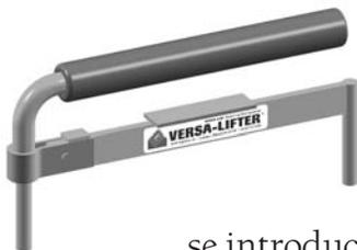
El levantador VERSA-LIFTER ayuda en la instalación de los muros de contención VERSA-LOK facilitando el levantamiento y la colocación de las unidades, especialmente en la hilada base. Las dos puntas de la herramienta se introducen en los orificios de la unidad VERSA-LOK. Al levantarse la manija, se fija la unidad a la herramienta facilitando así el desplazamiento de ésta y su colocación.
